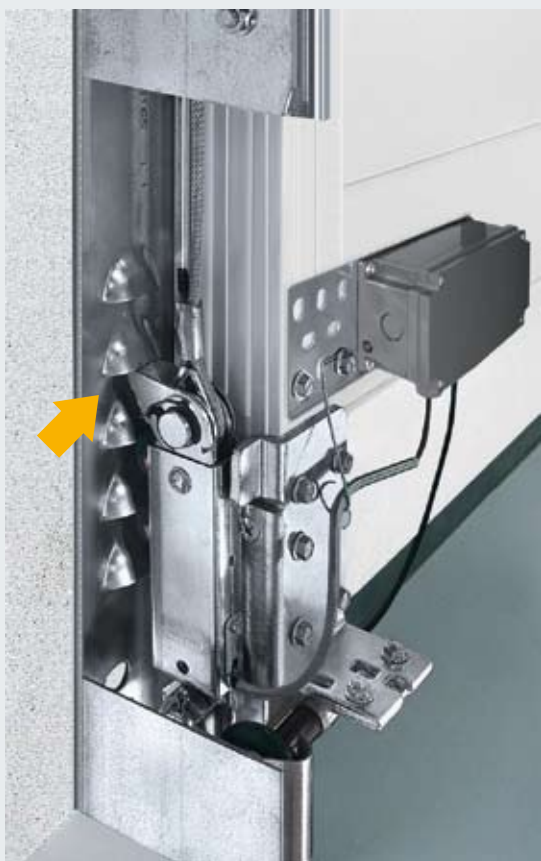
El gancho de bloqueo de la protección contra la apertura se enclava automáticamente. Al abrir la puerta el gancho vuelve a liberarse.
