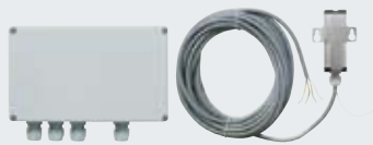
Receptor de relé de 2 canales HER 2 Con 2 salidas de relé libres de potencial, frecuencia 868 MHz, IP 65, tensión de servicio 24 V CC / 230-240 V CA, antena separada para uso en el exterior (IP 65), en carcasa de aluminio antivandalismo, con cable de conexión de 7 metros, de 3 hilos, unidad de evaluación para el interior
