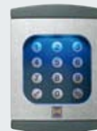
Pulsador codificado vía radiofrecuencia FCT 10b Con el pulsador codificado vía radiofrecuencia FCT 10b puede emitir hasta 10 códigos de radiofrecuencia (868,3 MHz). No hace falta tender cables. Iluminación del teclado con la primera pulsación.
