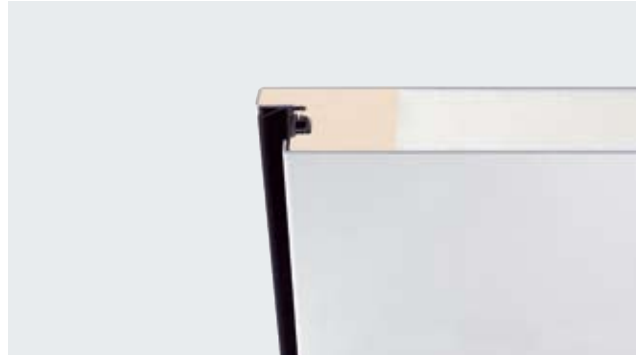
Alto aislamiento térmico gracias a la hoja con rotura térmica rellena de espuma PU dura.
